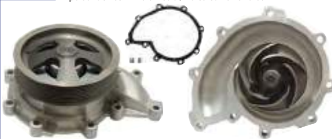
B-146 Impulsor de 105mm diámetro / Polea con 8 Ranuras
