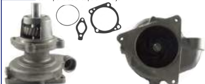
B-729 Con 4 perforaciones para montaje
